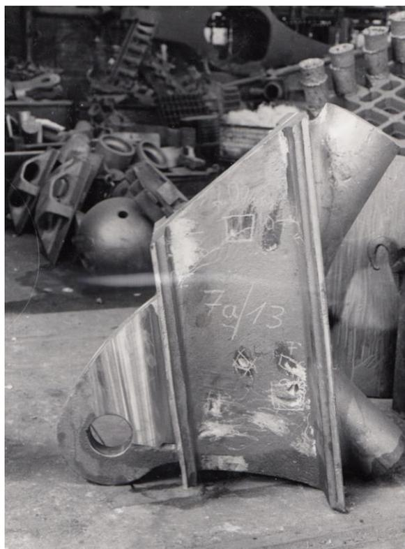
Inspection d'Ove Arup & Partners aux fonderies de Pohlig Heinz Bleichert-PHB, nœud de type 7A des poutres Warren avec des fissures et des défauts de fabrication mis en évidence avec le plâtre, en attente de subir des soudures de réparation, sans date (1974).
